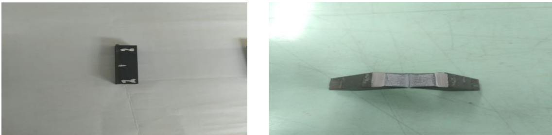
Gambar 3 Spesimen 2 sebelum dan sesudah pengujian impact dilakukan
