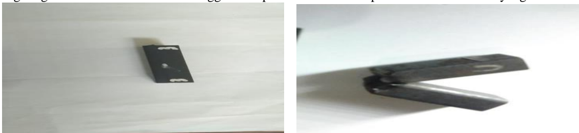
Gambar 4 Spesimen 3 sebelum dan sesudah pengujian impact dilakukan
