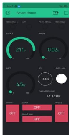
Gambar 19 Arus dan Tegangan yang terdeteksi pada tampilan aplikasi blynk
