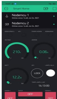
Gambar 18 Tampilan blynk yang telah terkoneksi dengan nodeMCU
