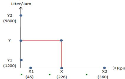
Gambar 11. Grafik Hubungan Antara kecepatan Pompa Dengan Laju Aliran pada 226 rpm
