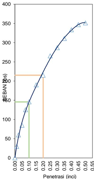
**Gambar 2.** Hasil Pengujian CBR Laboratorium tanah lempung lunak
