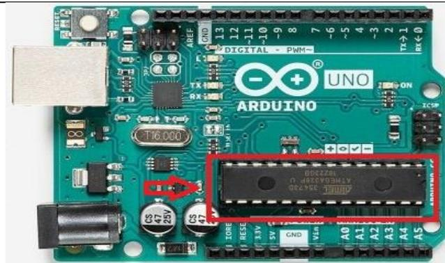
**Gambar 1** Mikrokontroler AVR
