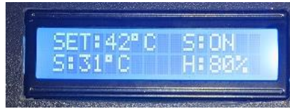
Gambar 5. Suhu dan kelembaban yang terdeteksi pada alat pengering
