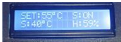
Gambar 11. Kondisi Suhu dan Kelembaban Pada Alat Setelah 7 Jam Pengeringan
