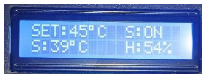
Gambar 9. Kondisi Suhu dan Kelembaban Pada Alat Setelah 1 Jam Pengeringan
