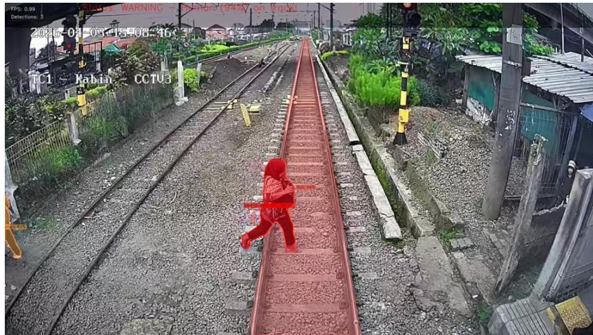
Gambar 9. Pengujian skenario penumpang tunggal di area rel — Status: WARNING — Human (94%) on track
