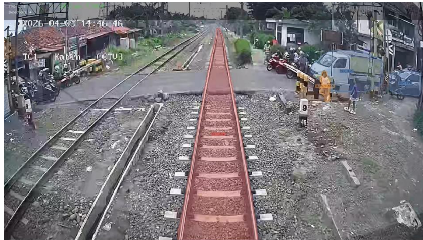
Gambar 7. Visualisasi pada perlintasan jalan dengan deteksi kendaraan dan pejalan kaki di luar area rel
