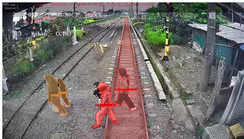
Gambar 8. Pengujian skenario penumpang masuk ke area rel — Status: WARNING — Human (96%, 95%) on track
