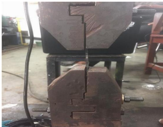
Gambar 2 Specimen Dashboard Mobil Dengan Cekam
