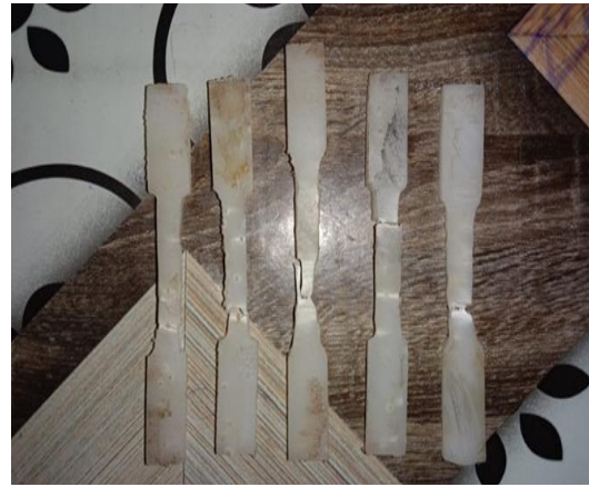
Gambar 7. Spesimen Sesudah Pengujian
