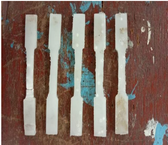
Gambar 6. Spesimen Sebelum Pengujian
