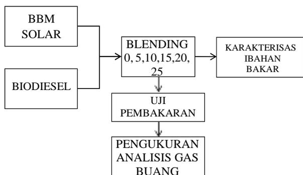
Gambar 1. Blok Diagram Kerja Pengambilan Data Secara Eksperimen
