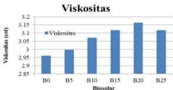
**Gambar 3.** Pengaruh Biosolar Terhadap Viskositas
