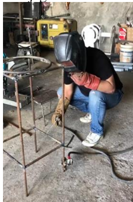
Gambar 8. Pengelasan Rangka Wastafel
