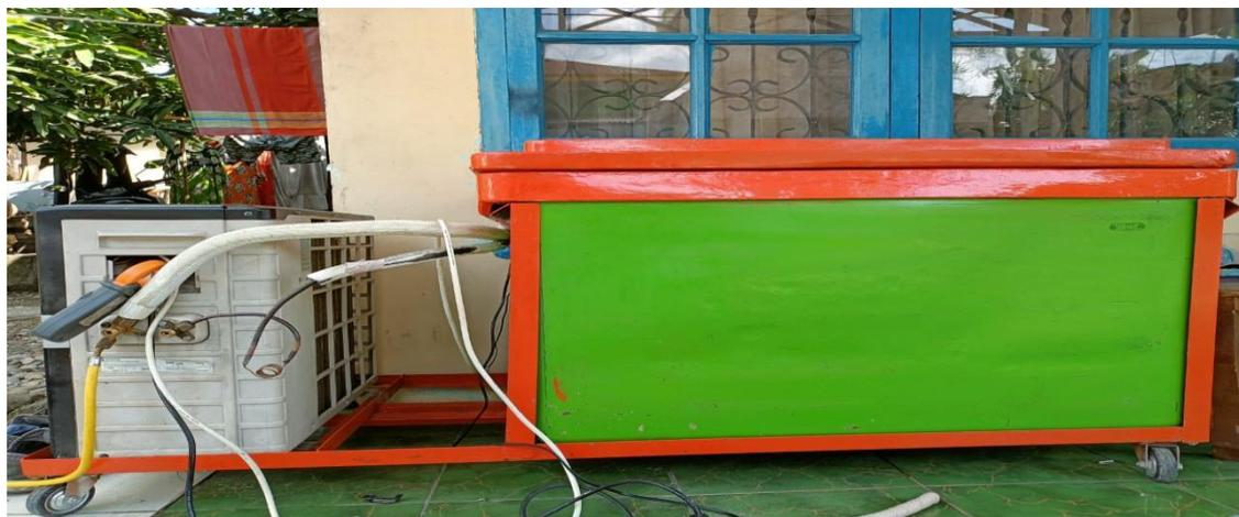
Gambar 4. Rancangan Water Chiller Modifikasi Outdoor AC split berkapasitas 1 kW siap dijadikan untuk Pelatihan
